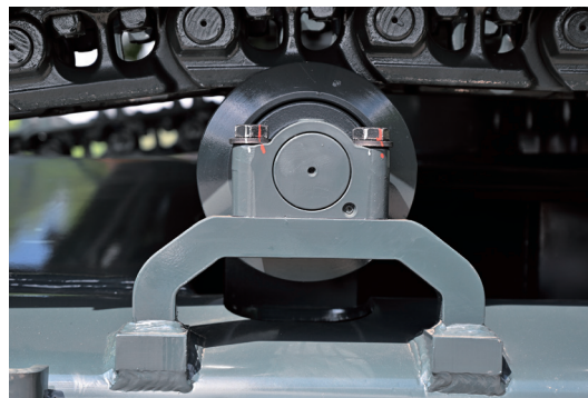
托链轮采用双边支撑，有效防止下坠
