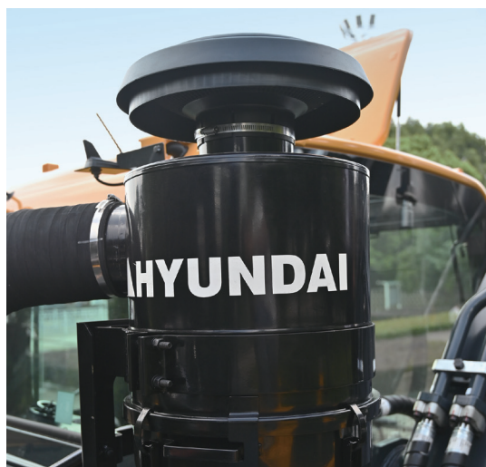
油浴式空气预滤，更适应矿山的恶劣工作环境，延长发动机使用寿命
