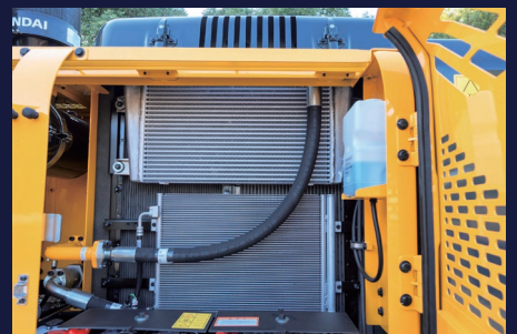
久经考验的散热系统，通过高恶劣环境耐久测试，散热性能极佳。配备防护网，有效防止散热器受异物阻塞
